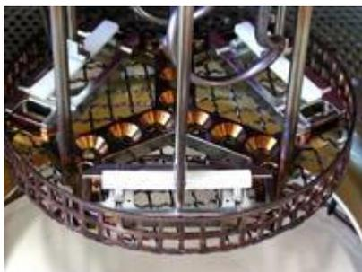
Bestimmung der Formbeständigkeit-Temperatur nach HDT
