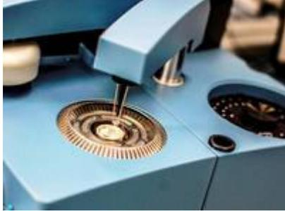
Automatische Beladung einer DSC-Messzelle
